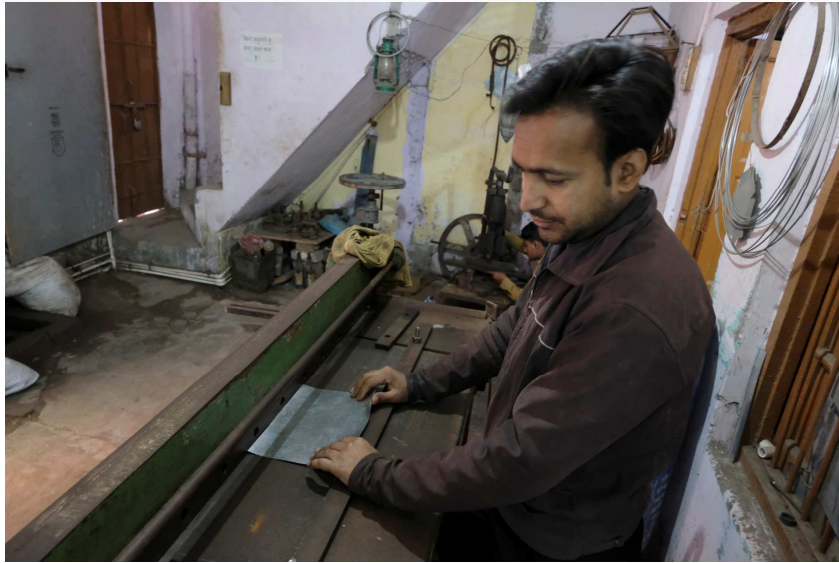
Schritt 6: Zuschneiden und Falzen der Kanten und Bodenteile
