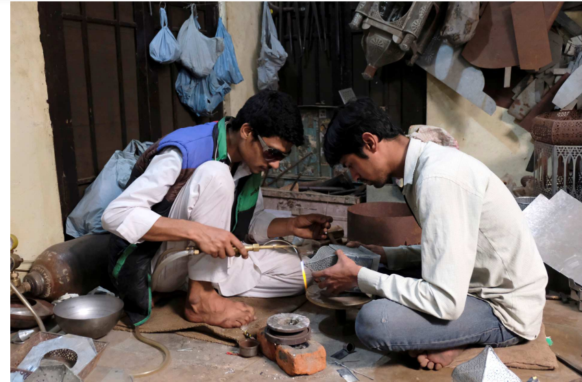
Schritt 7: Zusammenschweißen der Einzelteile
