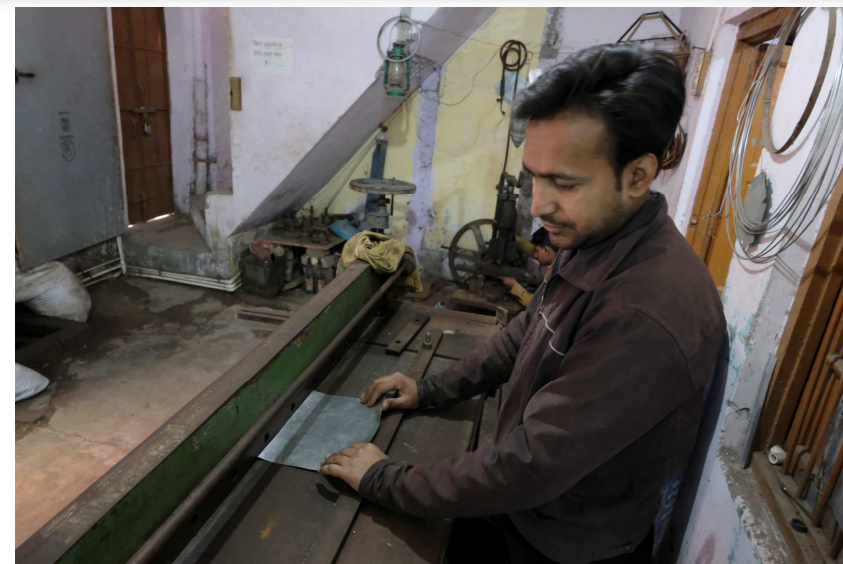
Schritt 1: Zuschneiden der Bleche für das Ätzbad vorbereitete Platte
