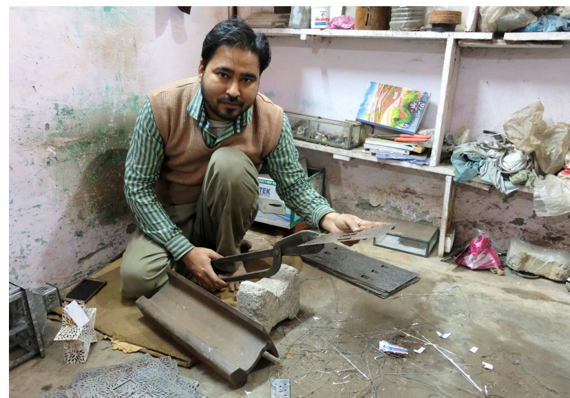
Schritt 5: Zuschneiden der einzelnen Formteile
