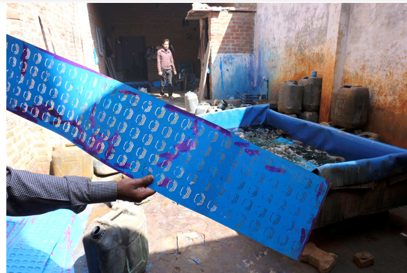
Das Blech an unbedeckten Stellen wird herausgelöst
