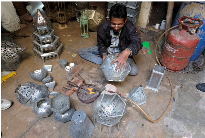
Schritt 6: Zuschneiden und Falzen der Kanten und Bodenteile
